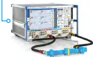
Измерение параметров материалов в волноводе
