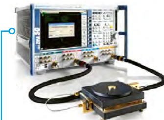
Измерение параметров пленок на основе резонатора
