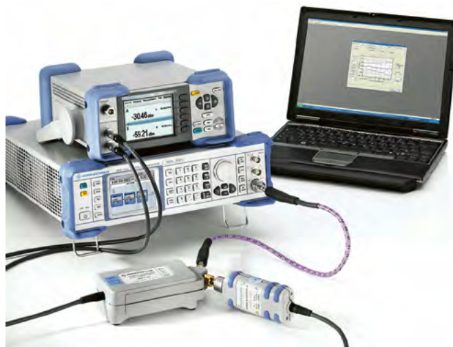
Измерительная установка для калибровки преобразователя мощности NRP-Z55
